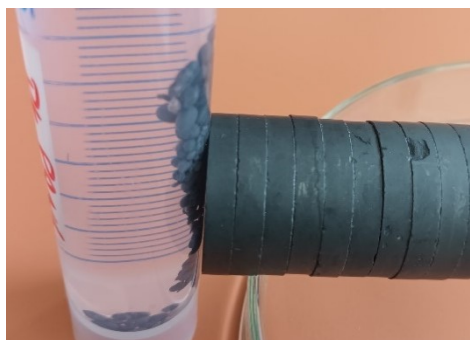
Obr. 1. Demonstrace možnosti separace připraveného sorbentu pomocí magnetického pole
