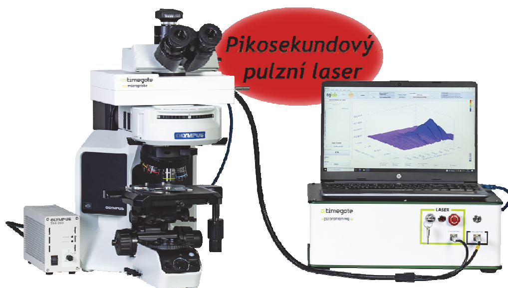
Obr. 4: Spektrometr PicoRaman M3 v kombinaci s optickým mikroskopem pro časově rozlišenou Ramanovu mikroskopii
