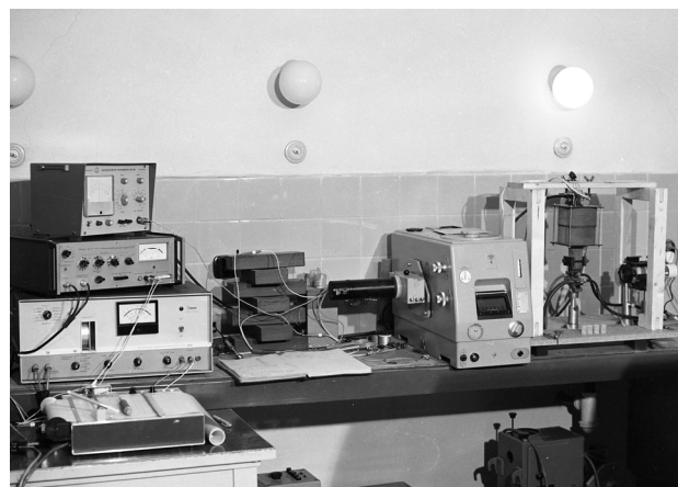
První experimentální aparatura korekce pozadí modulovaným magnetickým polem v grafitovém atomizátoru - Carbon rod Varian (1976)
